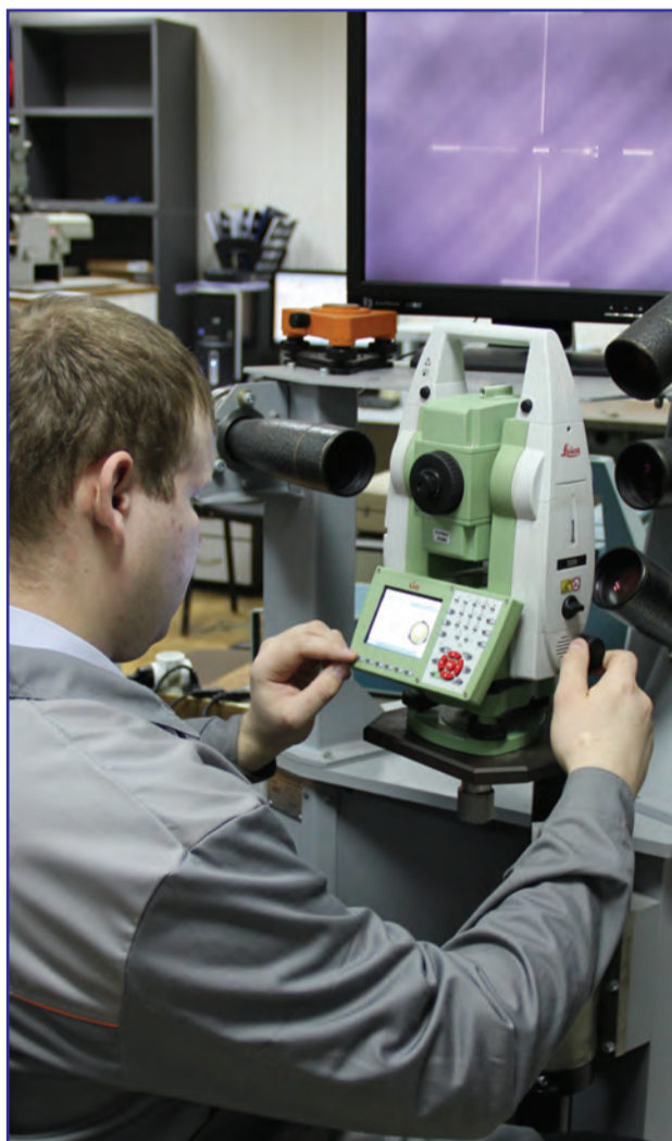
Рабочее место по испытаниям, поверке и калибровке оптических, цифровых и лазерных нивелиров, оптических и электронных теодолитов, тахеометров электронных
